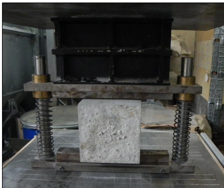
Slika 8.7: Prikaz preiskave cepilne natezne trdnosti
