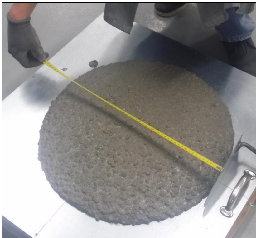
Slika 8.5: Prikaz meritve razleza
