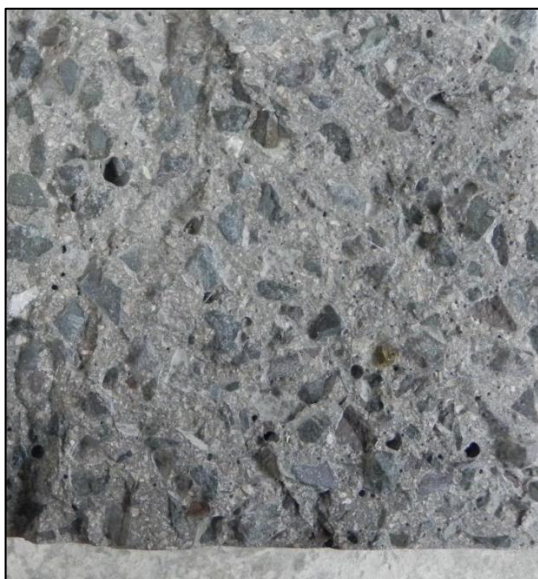
Slika 8.8: Prikaz porušenega prereza betonskega vzorca kot rezultat preizkusa cepilne natezne trdnosti
