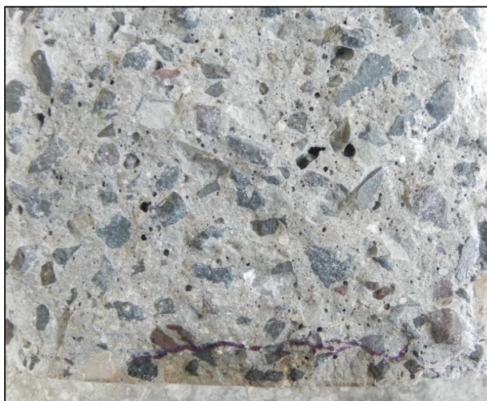
Slika 8.10: Prikaz preiskave prodora vode pod pritiskom
