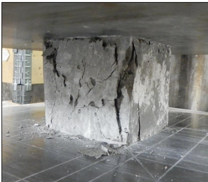
Slika 8.9: Prikaz preiskave tlačne trdnosti
