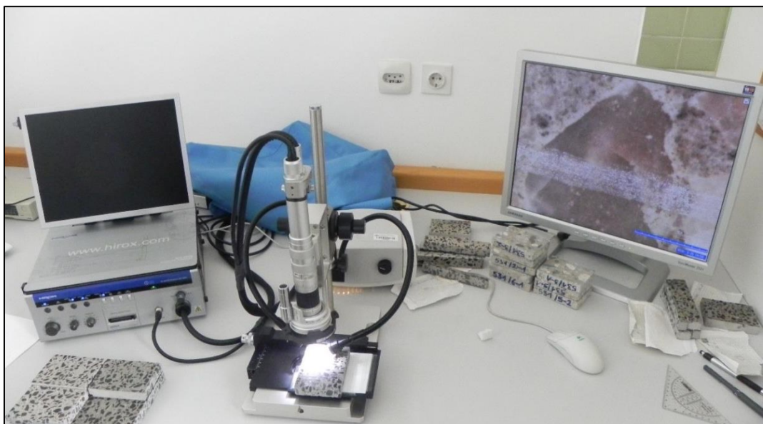
Slika 8.11: Digitalni video-mikroskopski sistem HIROX KH-3000
