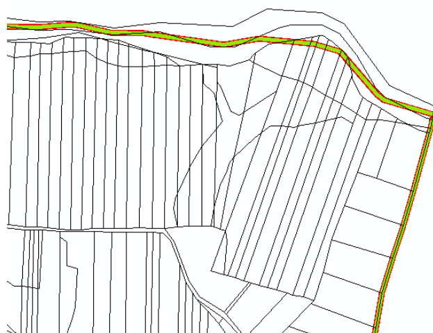
Slika 30: Primerjava podatkov poligona državne meje (zelena črta), poligona katastrskih občin (rdeča črta) in poligona parcel zemljiškega katastra (črna črta) - Prekmurje
