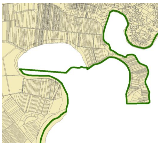
Slika 28: Primerjava podatkov poligona parcel ob meji (zemljiški kataster) in poligona slovenske meje (evidenca državne meje). Zelena črta predstavlja podatke iz evidence državne meje, sivo-rumene parcele pa predstavljajo podatke iz zemljiškega katastra.
