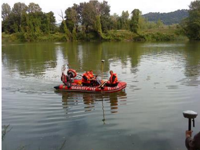
Slika 6: Meritve prečnega profila Save z ultrazvočnim globinomerom SonarMite (Grangeo d.o.o., 2011).
