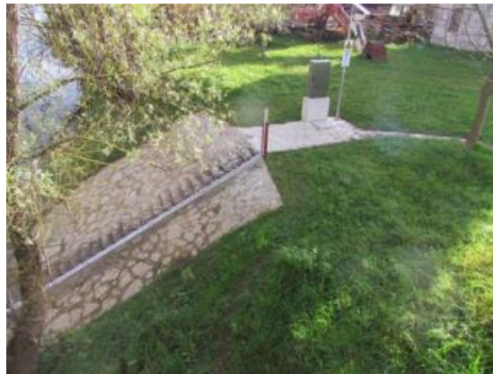
Slika 4: Vodomerna postaja s poševnim vodomernim trakom in vertikalno merilno lato za merjenje visokih vodostajev (ARSO, 2015)
