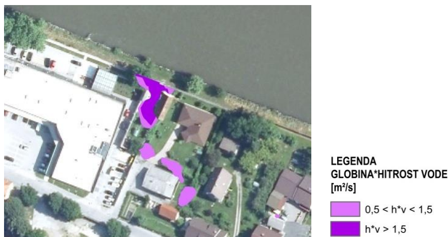
Slika 32: Območje, kjer je hitrost vodnega toka večja od 1 m/s pri verziji 3 (velikost celice 6 x 6 m).
