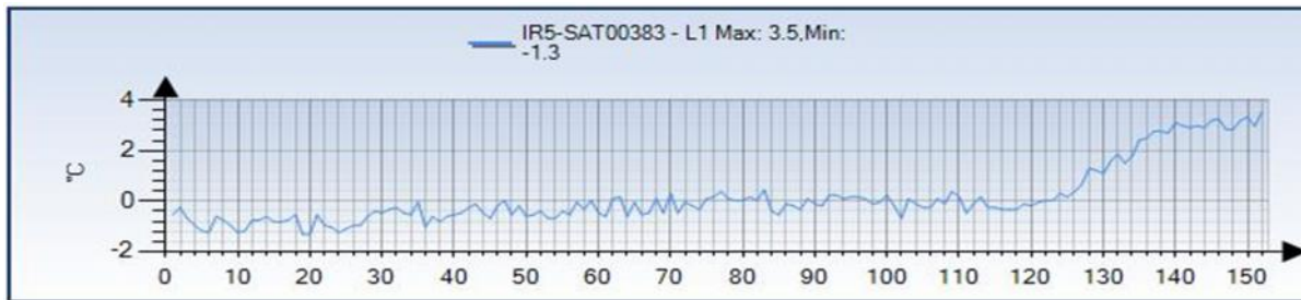
Slika 9: Potek temperature po daljici L1, na severni fasadi (izpis iz termograma posnetega 27. Januarja ob 23.00)
