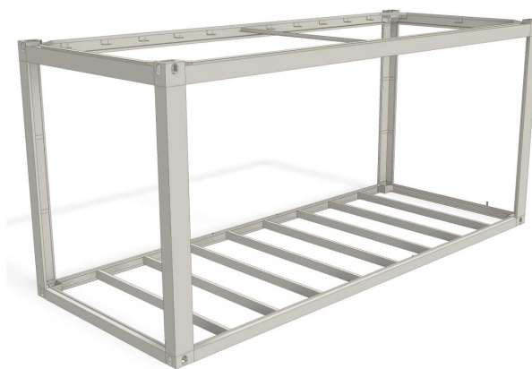
Slika 6: 3D model kontejnerja s stropom, podom in stebri.
