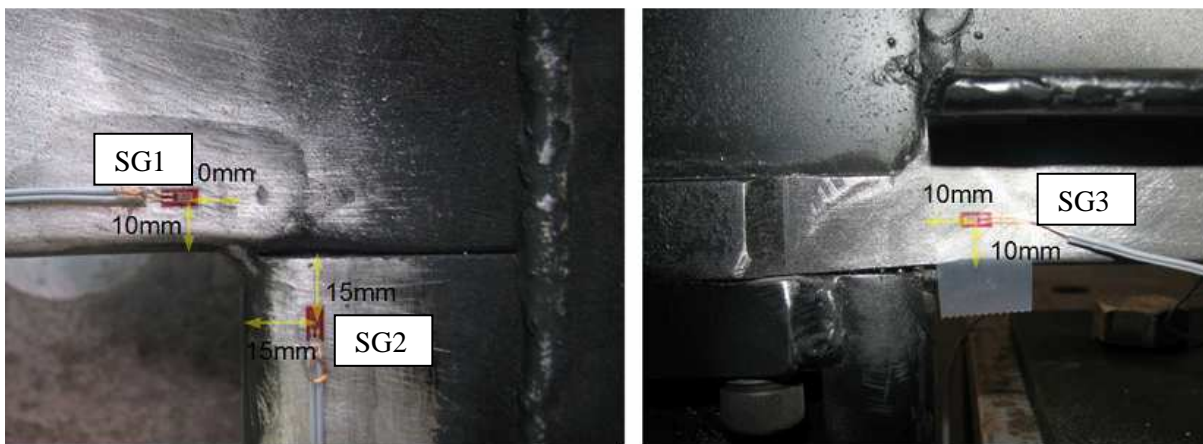
Slika 23: Lokacija merilnih lističev na testnih vzorcih SG1 in SG2 na zunanji strani in SG3, ki je na notranji strani vzorca.
