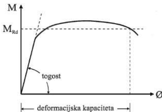
Slika 19: Rotacijska kapaciteta spoja (Beg).
