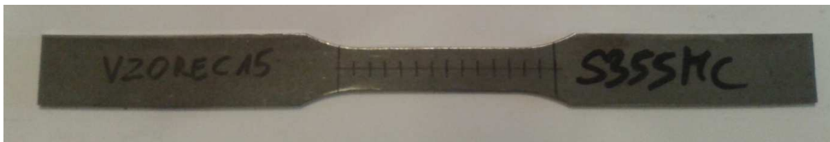
Slika 27: Oblika testnega vzorca, na katerem so zarisane črtice dodatno kontrolo raztezka, zaporedna številka in vrsta materiala iz katerega je vzorec narejen.
