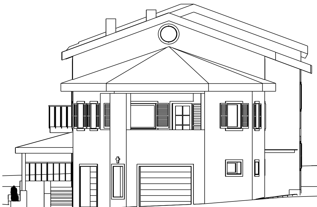
Slika 5.30: JV fasada, kjer je dobro vidna obravnavana streha (risano s programom REVIT)
