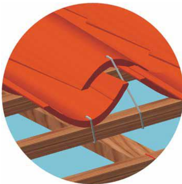
Slika 3.3: Detajl obešanja korcev na letve (vir: http://www.go-opekarne.si/ )
