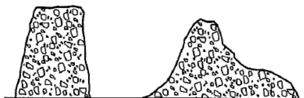
a). Pravilen posed b). Posed s porušitvijo preizkušanca
