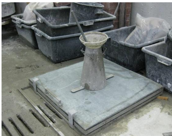
Slika 15 : Oprema za preizkus s posedom
