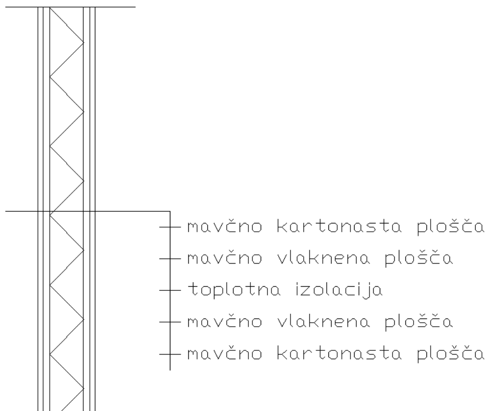
Slika 11: Konstrukcijski sklop notranje stene
