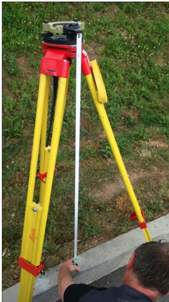
Slika 10: Merjenje višine instrumenta z merskim trakom in nastavkom
