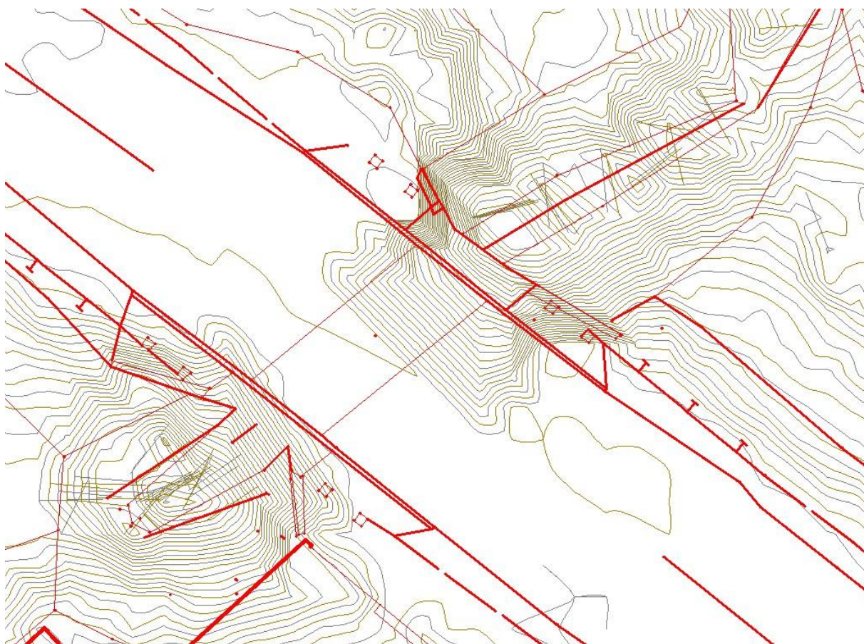
Slika 30: Prikaz napak v podatkih aerolaserskega skeniranja s primerjavo z geodetskim načrtom istega območja (lastni vir)
