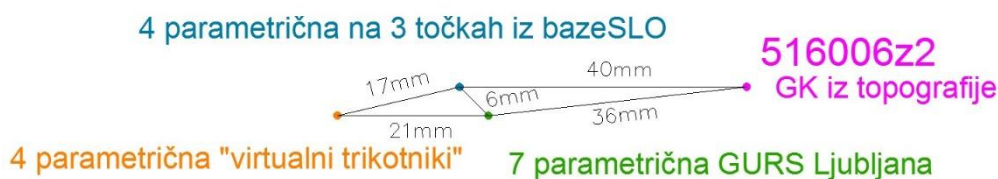
Slika 7: Primerjava različnih ravninskih transformacij geodetske točke (lastni vir)
