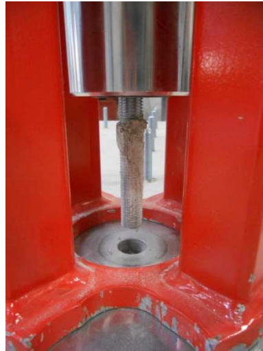
Slika 53: V celoti izvlečeno sprijemno sidro (lasten vir, 2015)
