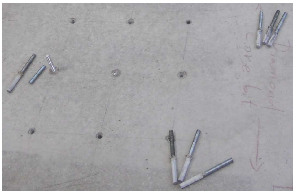
Slika 84: Porušni vzorci M12 sider vgrajenih z diamantno tehnologijo vrtanja (lasten vir, 2015)
