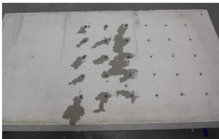
Slika 49: Izvrtine izvrtane s svedrom zalite z vodo (lasten vir, 2015)
