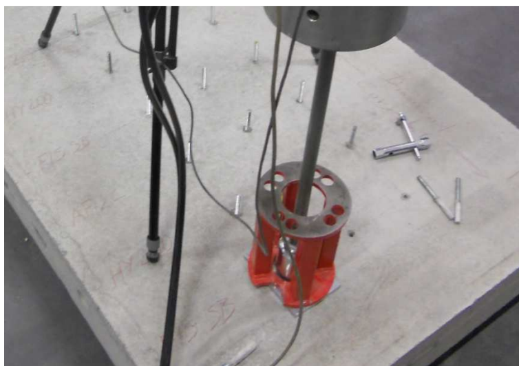
Slika 77: Izvlečni preskusi s sidri M12 v betonu C20/25 (lasten vir, 2015)
