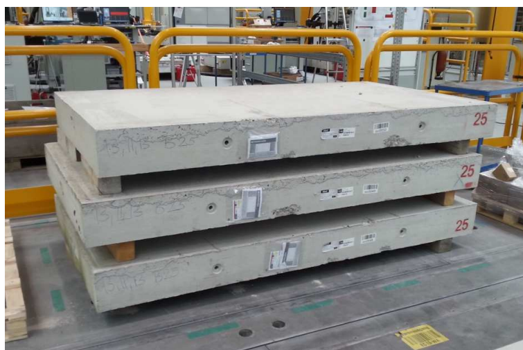
Slika 40: Betonske plošče namenjene preskušanju sider (lasten vir, 2015)
