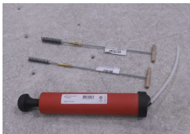
Slika 43: Ročna tlačilka in okrogli krtači d=14 mm in d=18 mm z ročajem (lasten vir, 2015)
