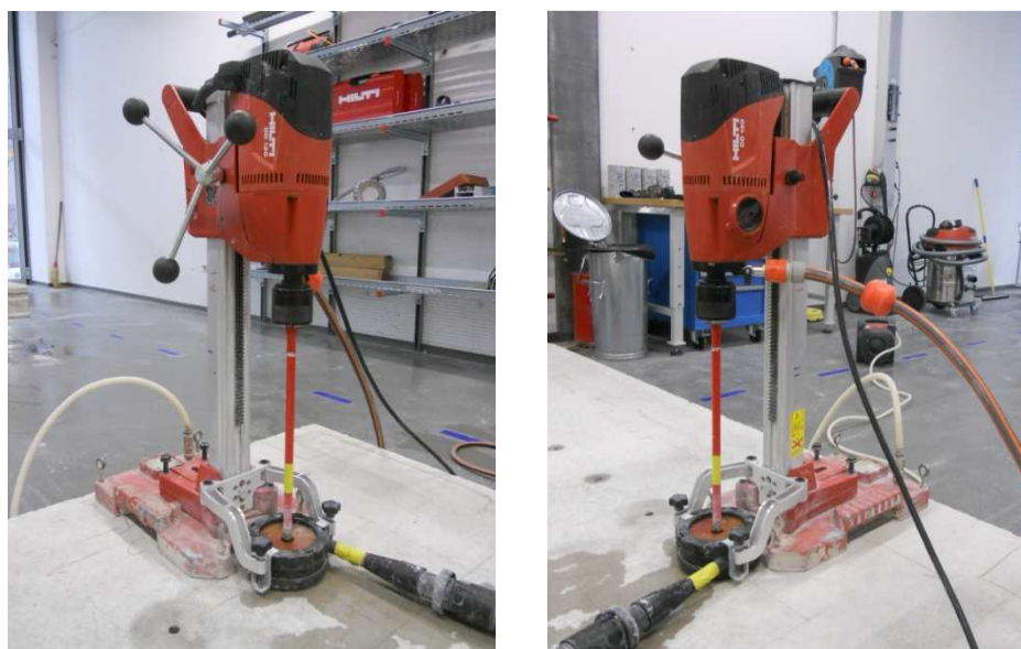
Slika 44: Sistem za diamantno vrтанje Hilti DD 120 (lasten vir, 2015)
