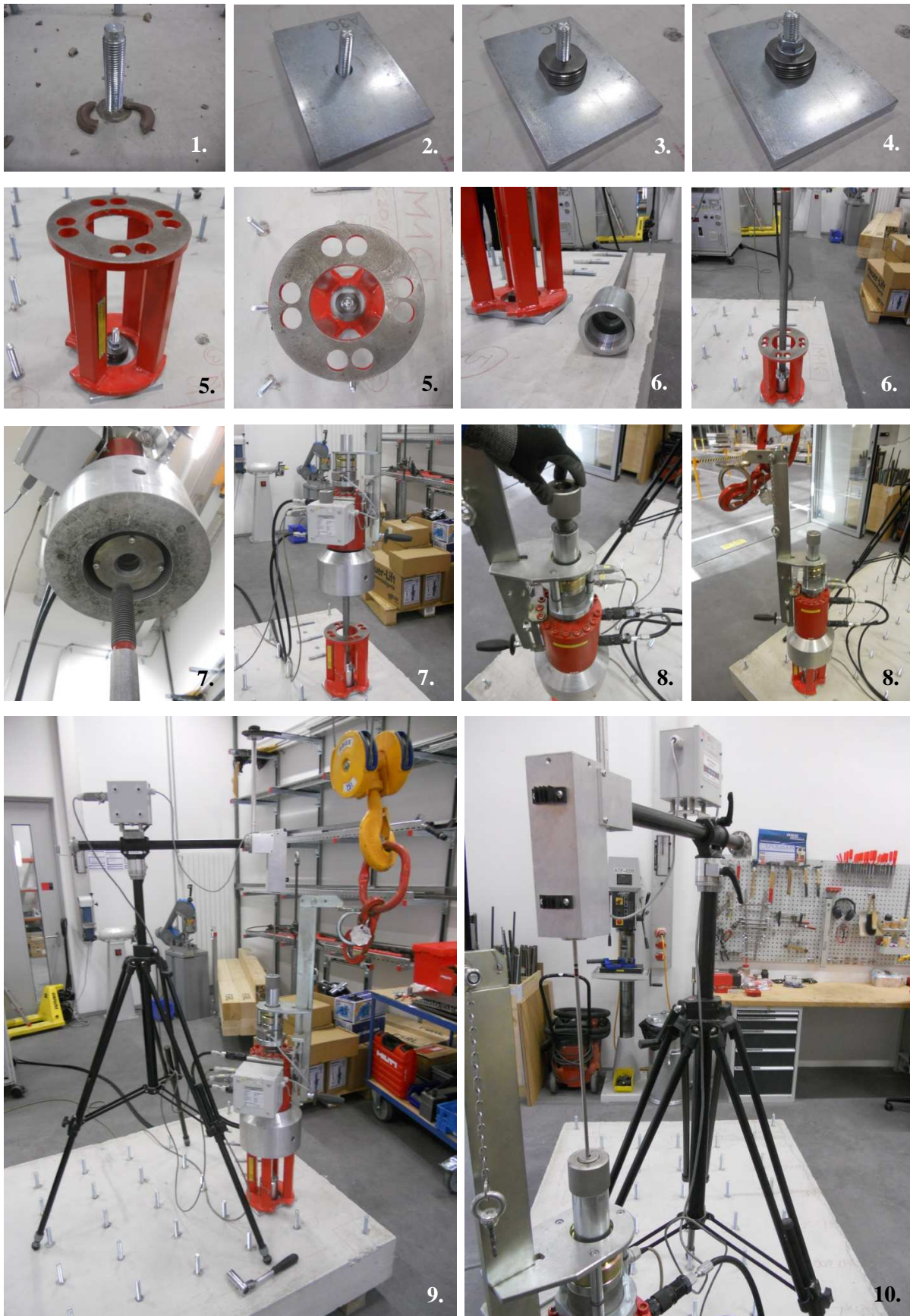
Slika 52: Prikaz namestitve opreme za izvedbo nateznega preskusa po korakih (lasten vir, 2015)
