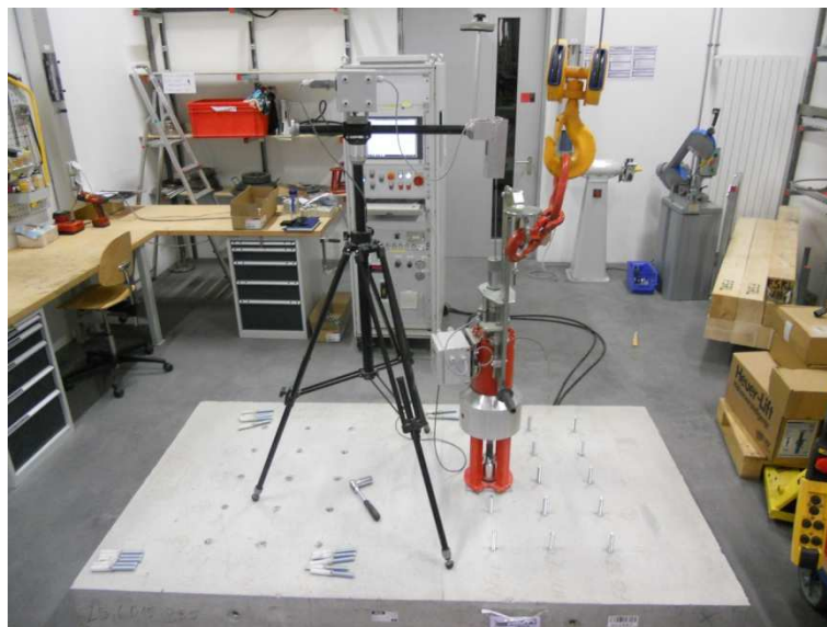
Slika 54: Izvajanje izvlečnih preskusov z ustrezno opremo v betonu C50/60 (lasten vir, 2015)
