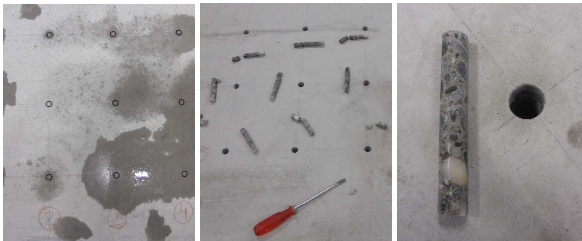
Slika 46: Odstranjena betonska jedra po diamantnem vrtnanju izvrtin (lasten vir, 2015)
