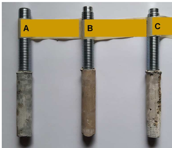
Slika 69: Porušni vzorci vseh treh proizvodov v betonu C50/60, diamantna krona (lasten vir, 2015)
