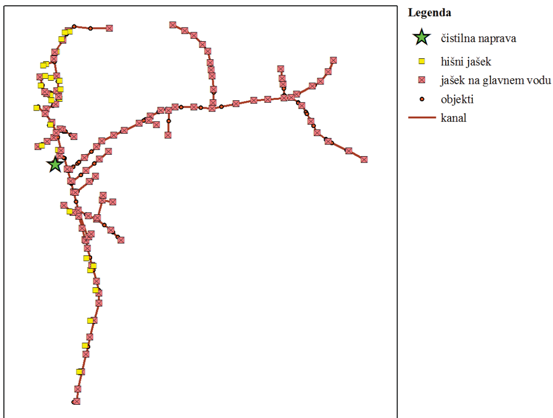
Slika 33: Obravnavano kanalizacijsko omrežje
