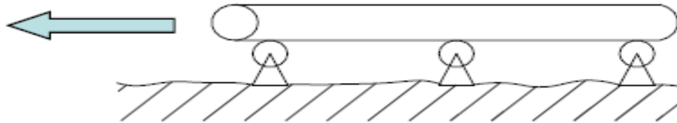
Slika 32: Prikaz uvleke cevovoda, kjer leži na valjčkih (www.vilkograd.com, pridobljeno 12.05.2016)
