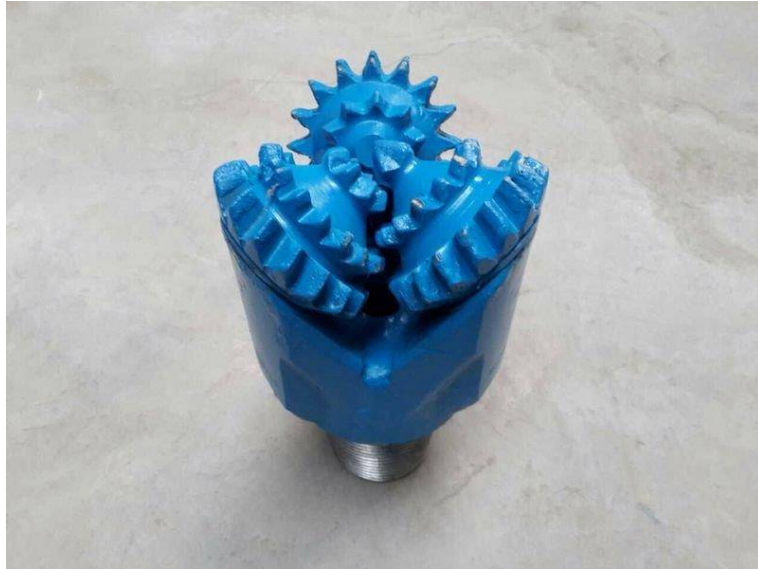
Slika 37: Vrtalna glava za trši teren, imenovana ang. Trikon Bore Head (lasten arhiv)
