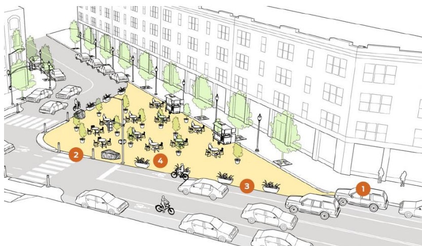
Slika 43 : Zasnova začasnega javnega trga
