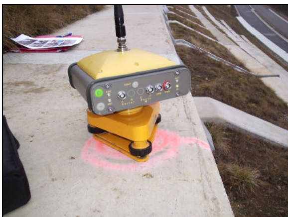
Slika 4: Stabilizacija točke CER2 z nameščeno anteno Topcon Hiper Plus. Foto: Mencin.
