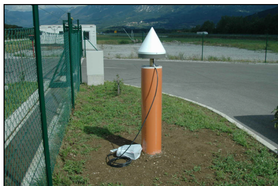
Slika 5: Stabilizacija točke BAZ2 z nameščeno anteno Topcon CR3. Foto: Kamnik.
