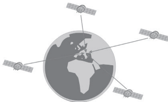
Princip določitve položaja v tehnologiji GNSS (Pavlovčič Prešeren, Stopar; 2005).
