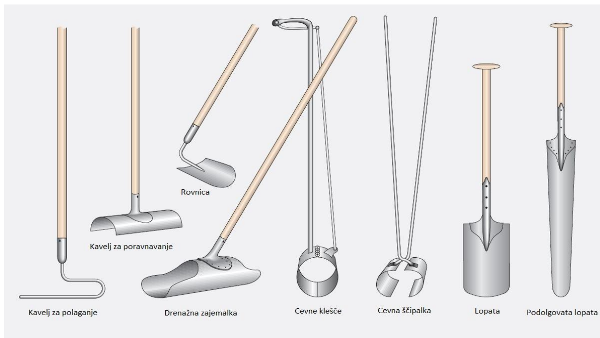
Slika 8: Specialno orodje, razvito posebej za ročno vgradnjo drenov (prirejeno po Nijland in sod., 2005:116)
