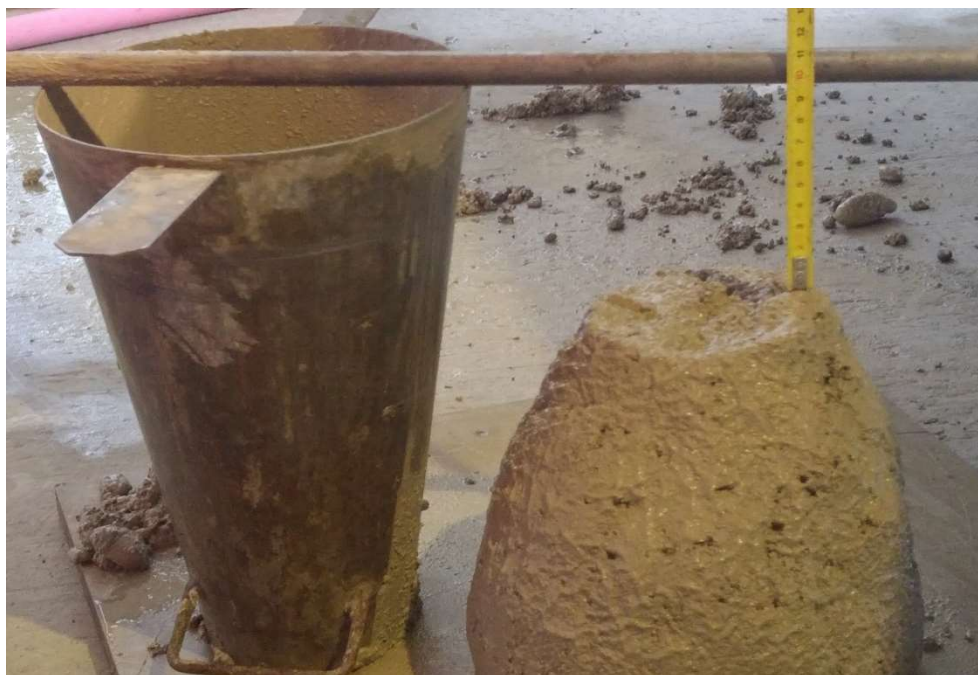
Slika 37: Odčitavanje poseda sveže betonske mešanice
