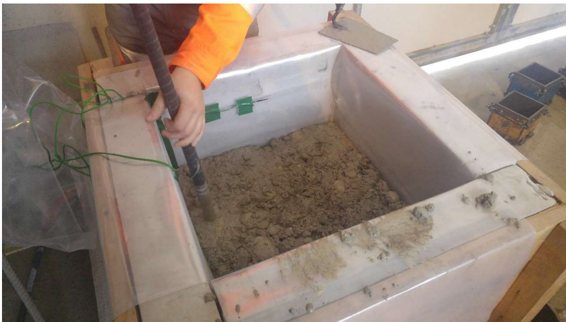
Slika 31: Vgrajevanje betona v kocko (vir: lasten)
