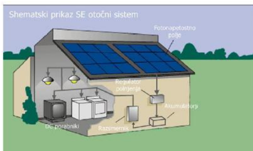
Slika 3: Prikaz otočnega sistema (Bisol, 2015)
