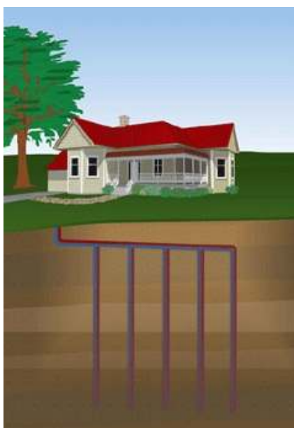
Slika 7: Vertikalna zemeljska sonda (vir slike: [28])
