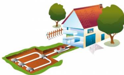
Slika 6: Horizontalna zemeljska sonda (vir slike: [28])
