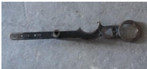
Slika 27: Hidrantni ključ za odpiranje nadzemnega hidranta, ki se namesti na zgornji del nadzemnega hidranta (lasten vir, 2015)
