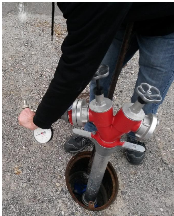
Slika 55: Izpust zraka iz ročnika je pomemben zaradi pravilne izmere tlaka na hidrantu
