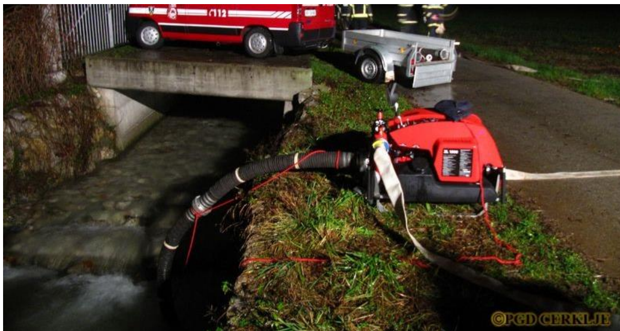
Slika 23: Črpanje vode z motorno črpalko iz bližnjega potoka (PGD Cerklje, 2015)
