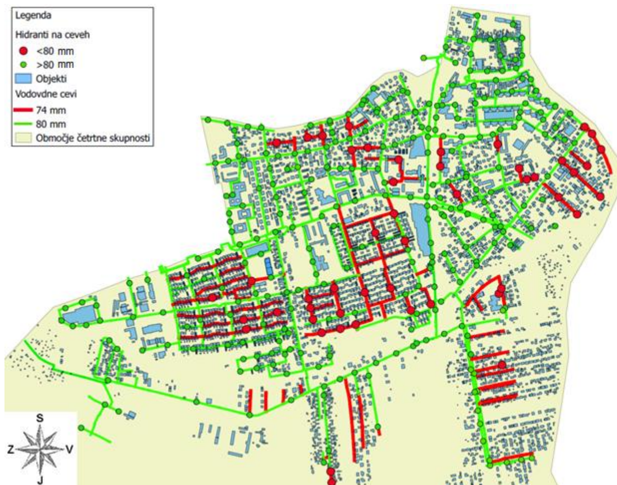
Slika 64: Ustreznost vgradnje hidranta glede na dimenzije vodovodne cevi - zelena barva prikazuje premere cevi večje kot 80 mm in predstavlja pravilno vgrajene hidrante glede na premer vodovodne cevi, rdeča barva predstavlja premere cevi do 80 mm in nepravilno vgrajene hidrante glede na premer vodovodne cevi
