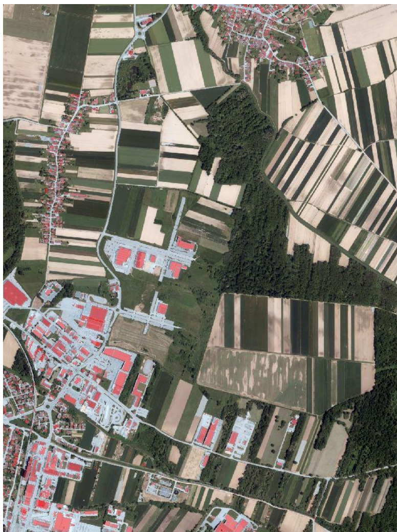
Slika 28: Rezultat klasifikacije ortofota na objektna razreda pozidane površine (modro) in stavbe (rdeče).
