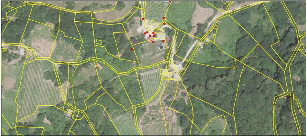
Slika 6: Izsek podlage, uporabljene na terenu za določevanje območij izmer ter identifikacijo dodatno izmerjenih veznih točk
