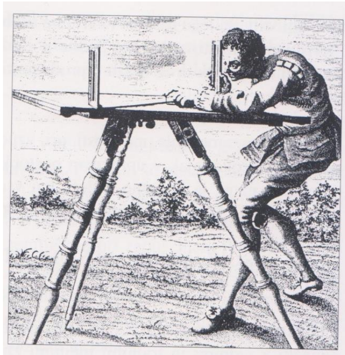
Slika 2: Izvedba meritev z mersko mizo (vir: Mlakar 1996: 19)
