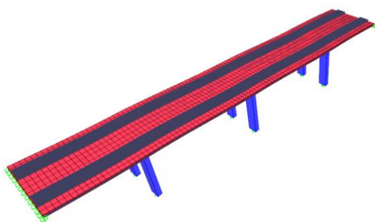
Slika 14: Linijski in lupinasti model - Prva nihajna oblika - Translacijska v vzdolžni smeri X ( T_1 = 0,515 s)
