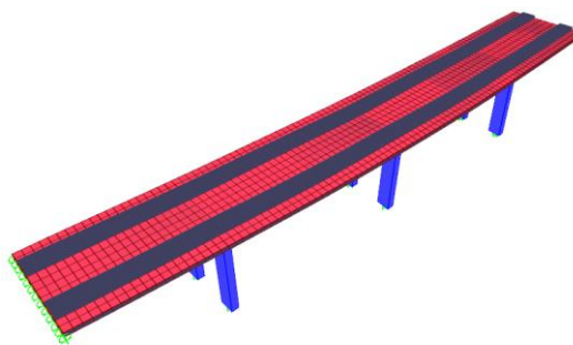
Slika 15: Linijski in lupinasti model - Druga nihajna oblika - Translacijska v prečni smeri Y ( T_2 = 0,209 s)
