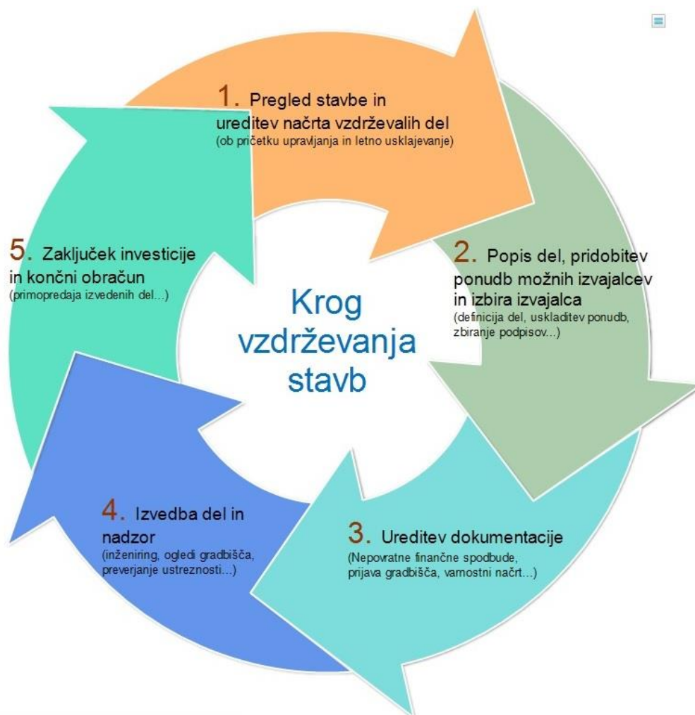
Slika 7: Moj predlog zaključenega kroga vzdrževanja večstanovanjskih stavb
