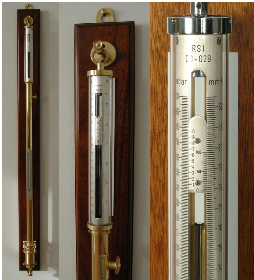
Slika 13: Živosrebrni barometer s skalo (mbar in mmHg) z nonijem [S8]
