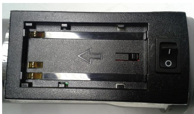
Slika 22: Nosilec baterije s klecnim stikalom
