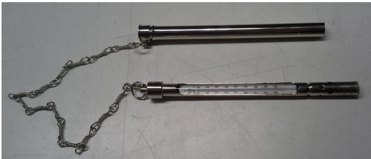
Slika 2: Alkoholni termometer za uporabo na terenu
