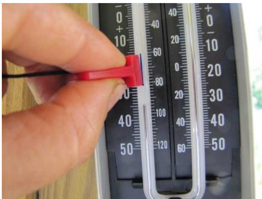
Slika 8: Premik plavača z magnetom za ponastavitev termometra [S6]
