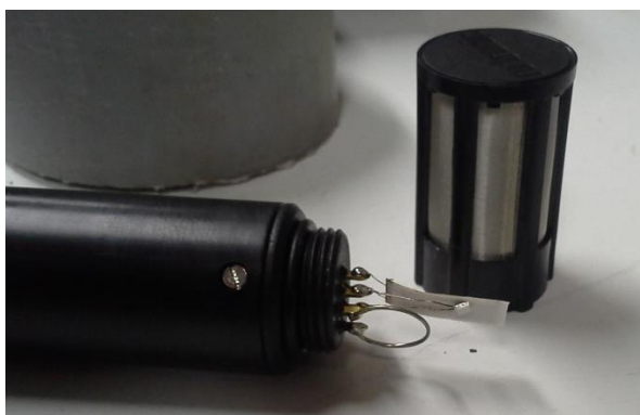
Slika 29: Odstranjen zaščitni filter sonde
