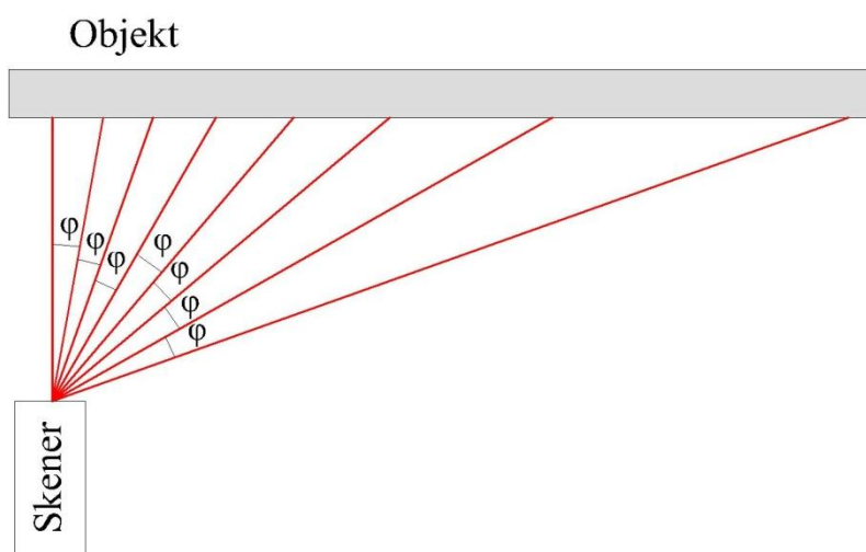
Slika 17: Ločljivost in gostota točk v odvisnosti od oddaljenosti skenerja od objekta in od vpadnega kota
