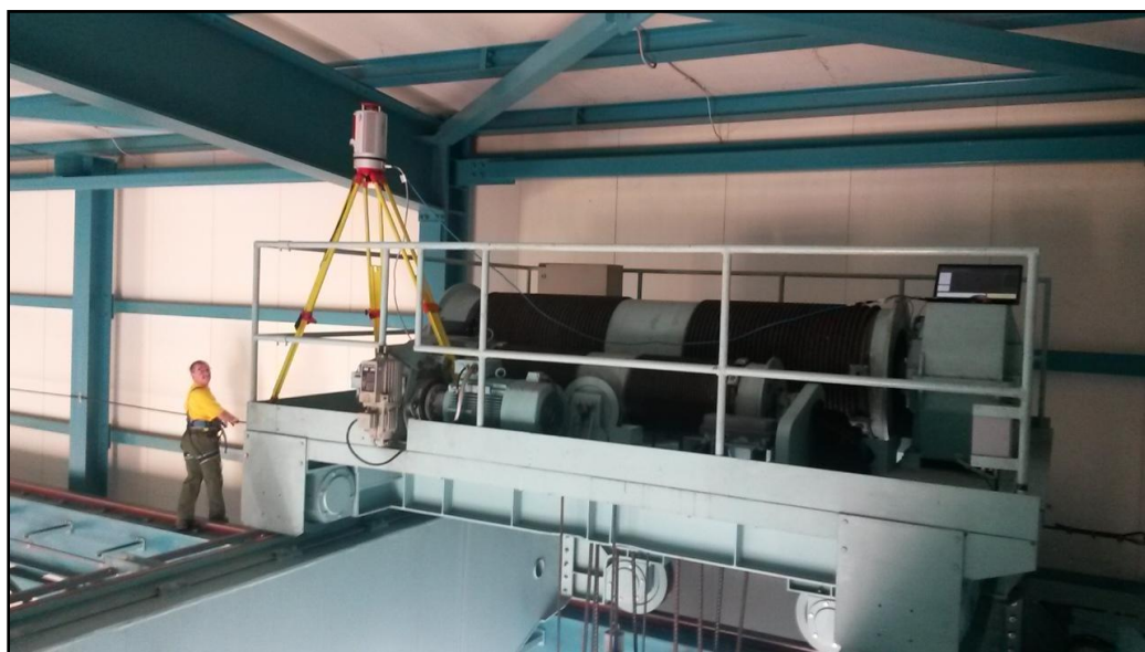
Slika 29: Terestrični laserski skener RIEGL VZ-400 povezan s prenosnim računalnik med skeniranjem
