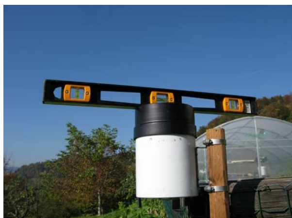
Slika 10: Dežemer številka 6 med postavljanjem
