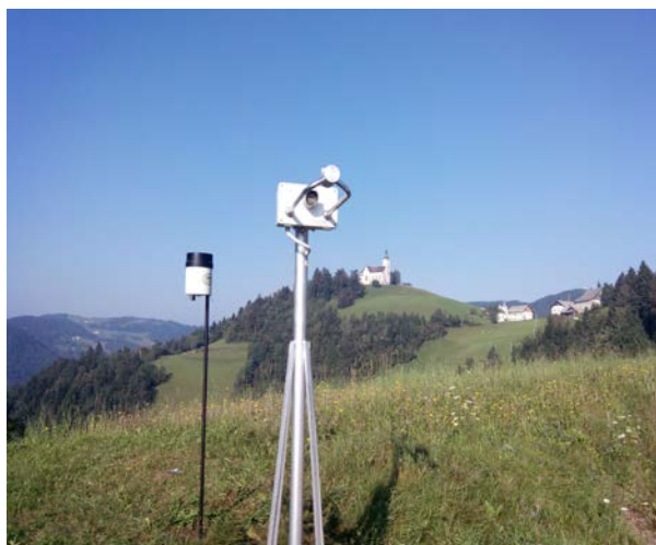
Slika 12: Disdrometer Thies Clima in avtomatični dežemer na Črnem Vrhu nad Polhovim Gradcem
