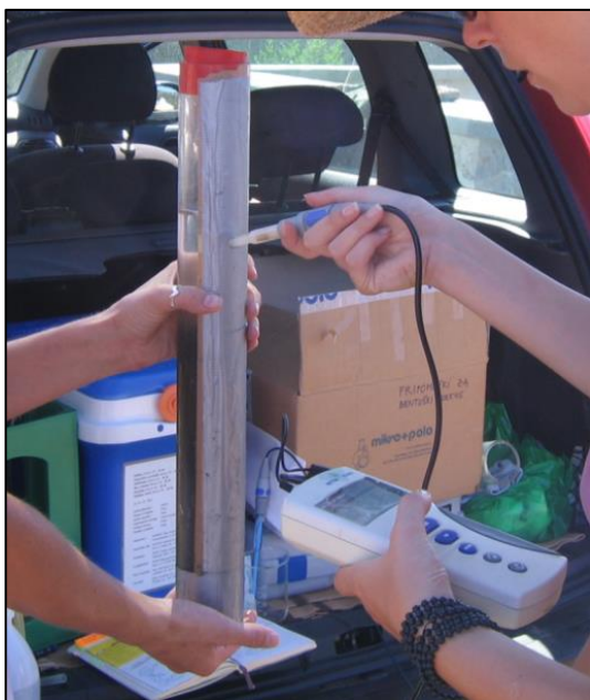
Slika 10: Merjenje pH in redoks potenciala ( Eh ) recentnega morskega sedimenta (avtor fotografije: dr. Tadej Dolenc)
