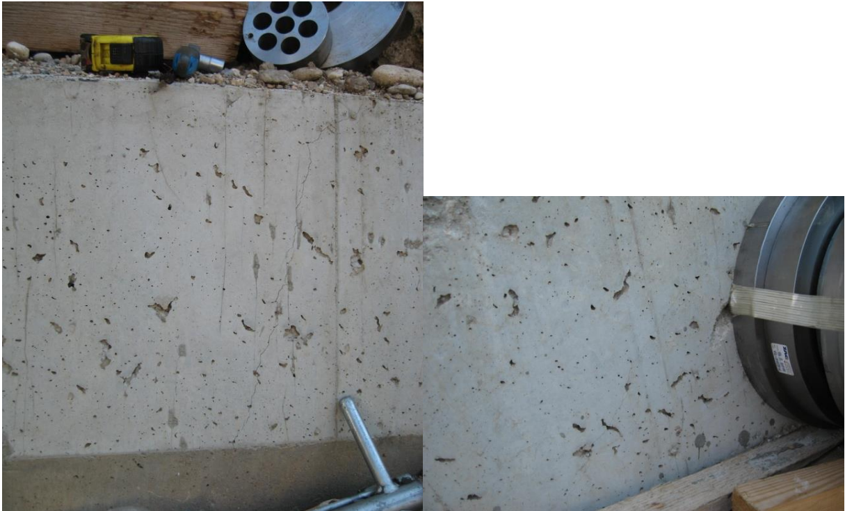
Sliki 37 in 38: Pri TS12 je prišlo do strižnih razpok grede pri 900 kN. Sliki prikazujeta razpoko, ki je pri tem nastala. (Vir: lastni fotografiji)
