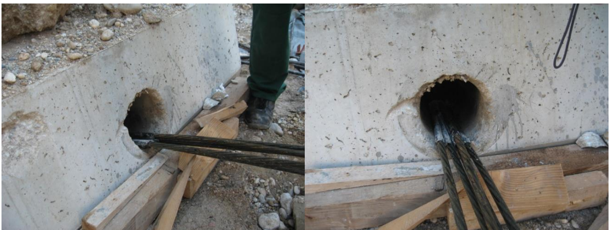
Sliki 39 in 40: Po razbremenitvi se je greda pomaknila nazaj na prvotno mesto in razpoka se je zaprla. (Vir: lastni fotografiji)
