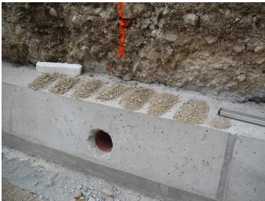
Slika 35: Izpihana zemljina po vrsti od površine (levo) proti dnu (desno). Skrajni desni iz 14,5m. (Vir: lastna fotografija)
