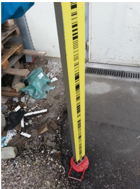
Slika 19: Invar nivelmanska lata s kodno razdelbo, ki jo postavljamo na podložko za lato.
