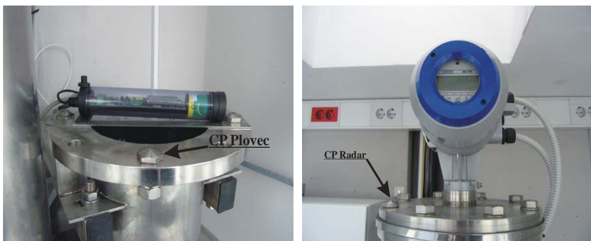
Slika 16: Kontaktna točka na klasičnem mareografu s plovcem - CP_{pl} (levo) in kontaktna točka na mareografu z radarjem - CP_r (desno)
