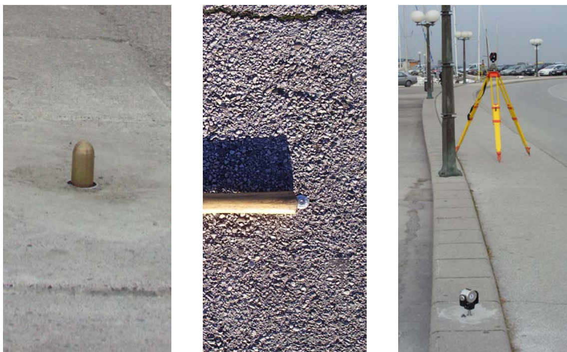
Slika 21: Stabilizacija merske točke z varnostnim pokrovom (levo), stabilizacija stojišča instrumenta (sredina), merska točka in ekscentrično stojišče (desno)
