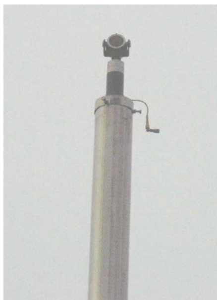
Slika 19: Merska prizma na nosilcu antene GPS (levo) in antena GPS na nosilcu (desno)
