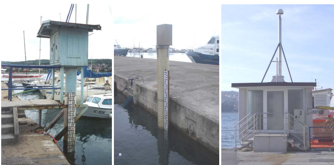
Slika 14: Star mareograf (levo), prestavljen star mareograf (samo cev s plovcem) (sredina), nov mareograf s permanentno GPS postajo (desno)
