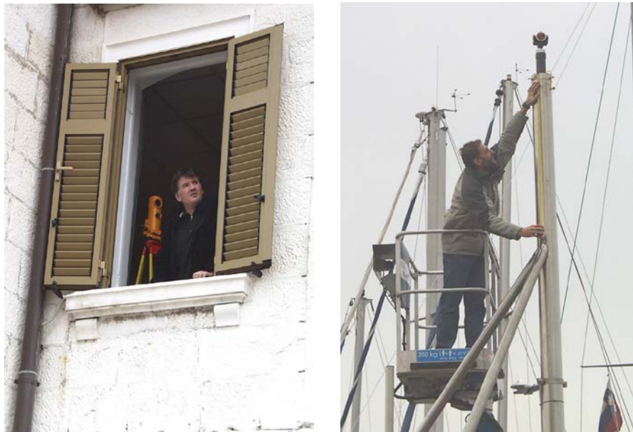
Slika 32: Niveliranje s preciznim nivelirjem Carl Zeiss Ni007 na anteno GPS
