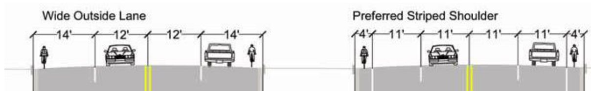
Slika 2-2: Primer rekonstrukcije, kjer razširimo robni pas in tako pridobimo 3' (90 cm) uporabne širine in 1' (30 cm) za izvedbo odvodnjavanja (Maryland SHA Bicycle and Pedestrian Design Guidelines, 2013)
