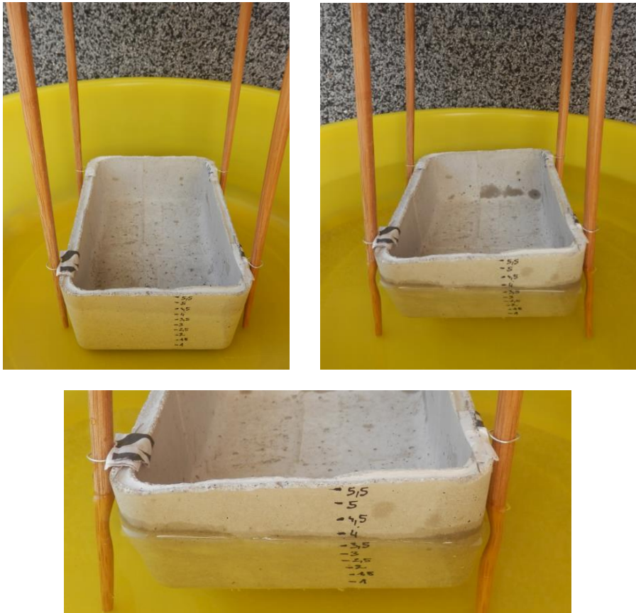
Slike 31: Preizkus plovnosti votle betonske školjke
