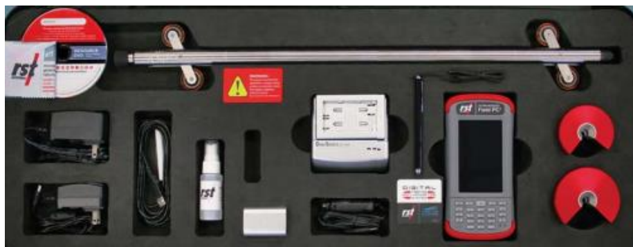
Slika 63: Elementi digitalnega biaksialnega MEMS inklinometra (RST INSTRUMENTS, 2015)
