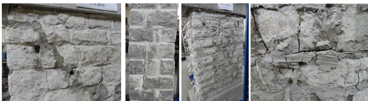
Slika 8.16: Poškodba zidov pri tlačnih testih: poškodovanost na licu zidu in razpoka med slojema na strani pri injektiranem zidu (levi dve) ter poškodovanost injektiranega, z NSM utrjenega ter povezanega zidu ter porušitev stika med malto in vrvico na sredini zidu (desni dve)
