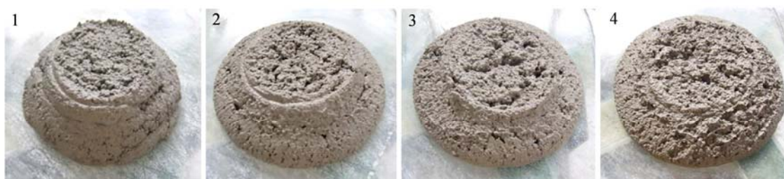
Figure 4.9: Spread tests of mortar with various water/binder ratios [251] Slika 4.9: Razlez vzorcev malte z različnimi vodovezivnimi razmerji [251]
