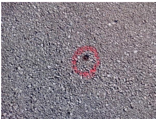
Slika 20: Stabilizacija izmeritvene točke s kovinskim žebličkom
