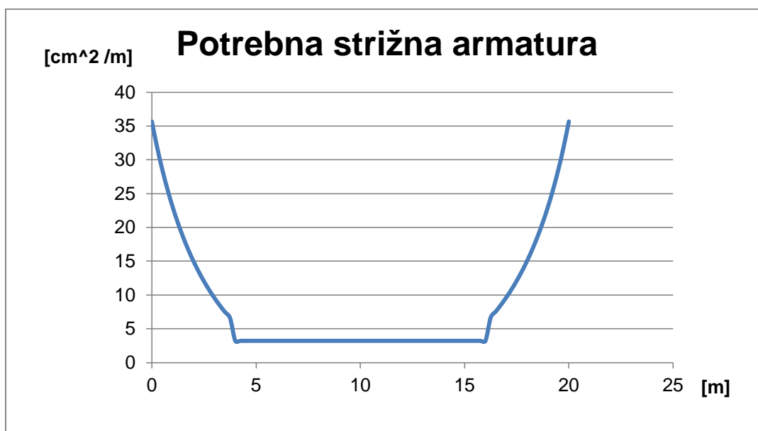
Slika 42: Prikaz potrebne strižne armature v nosilcu
