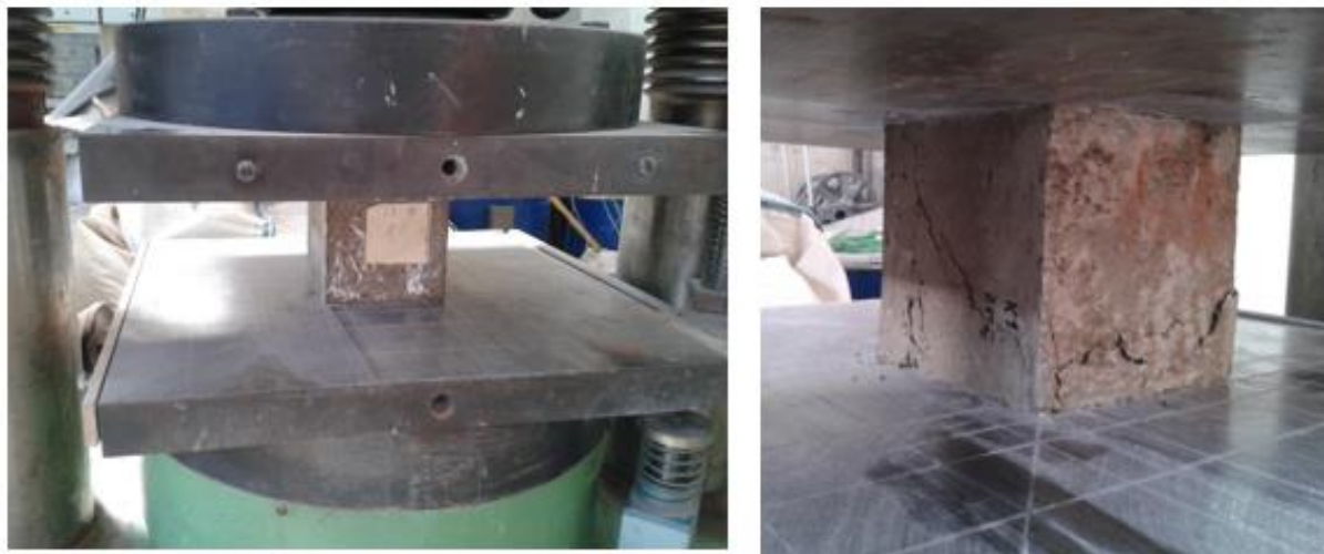
Slika 18: Preša za določanje tlačne trdnosti betona (levo) in zdrobljen preizkušaneec po tlačni obremenitvi (desno)
