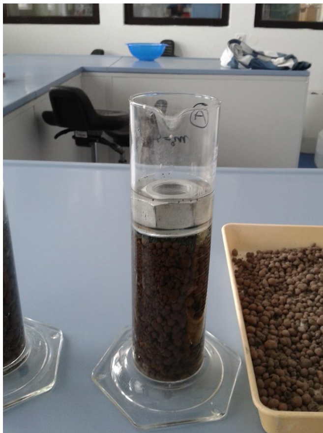
Slika 11: Vzorec lahkega agregata za določitev vpijanja vode
