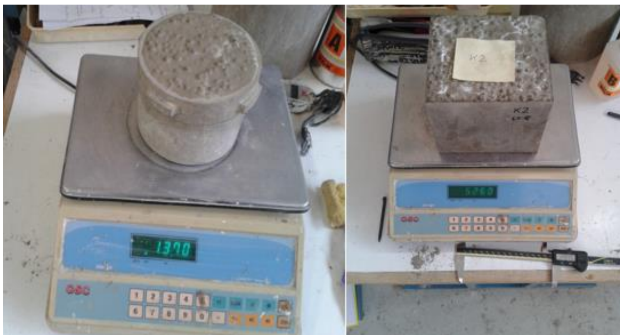
Slika 17: Določanje prostorninske mase svežega in strjenega betona
