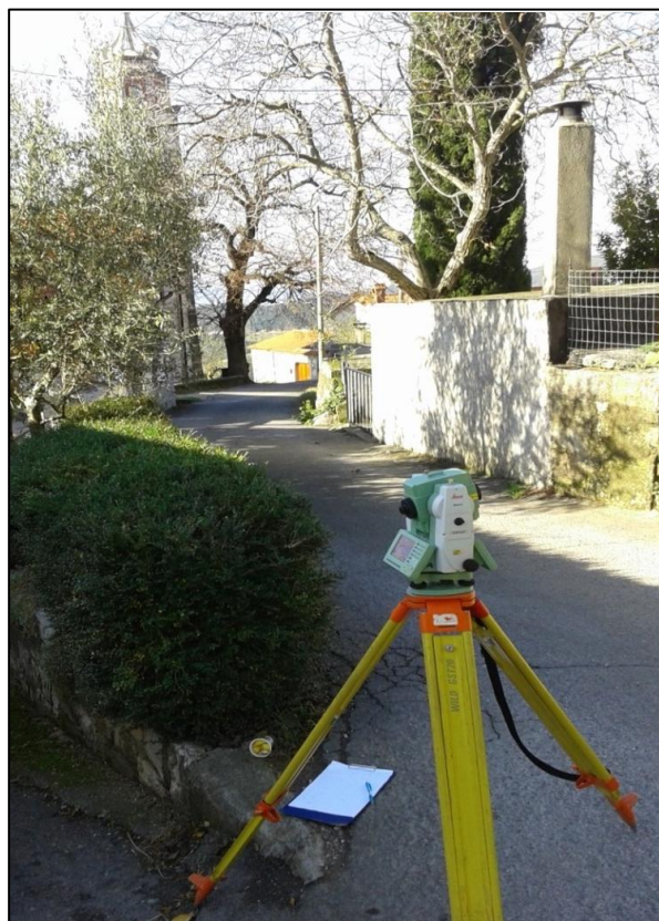
Slika 2: Tahimeter Leica Geosystems TCRP1201+ R1000 na stativu
