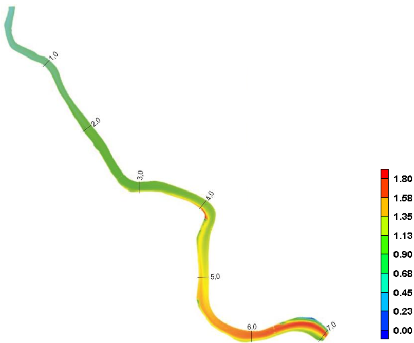
Slika 53: Koncentracije plavin v akumulaciji Vrhovo v času t = 2 h ( Q \sim 1080 m 3 /s) – v povprečju največje koncentracije plavin znotraj simulacije Figure 53: Sediment concentration comparison in the reservoir at t = 2 h – on average, the highest sediment concentrations of the simulation period
