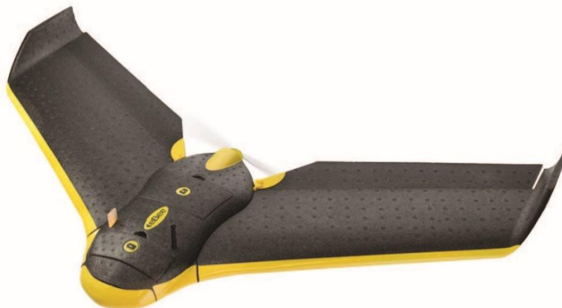
Slika 5: Brepilotni letalnik eBee (senseFly, 2013)
