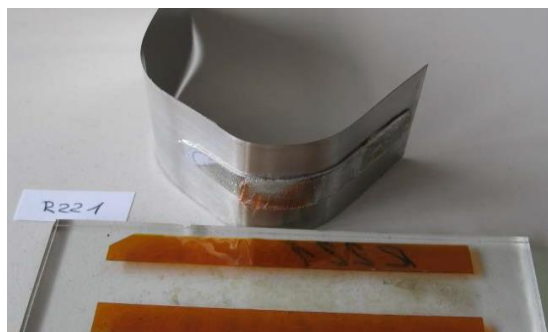
Slika 29: Vzorec R221 po končanem postopku lupljenja z vsebnostjo 0,0025 % aluminija
