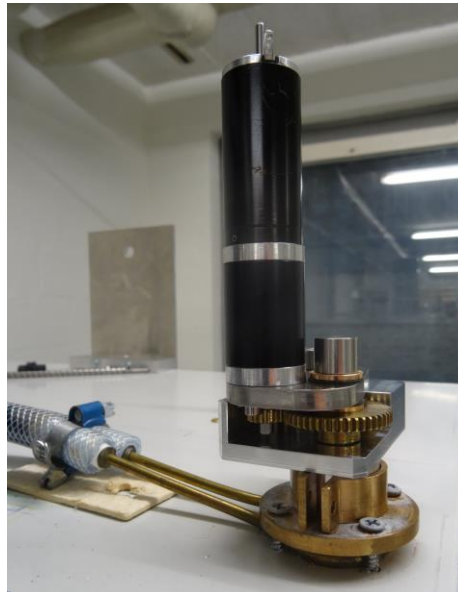
Slika 40: Elektromotor z mehanizmom za premikanje vozička
