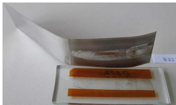
Slika 30: Vzorec R223 po končanem postopku lupljenja z vsebnostjo 0,0025 % aluminija
