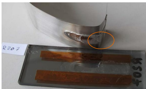
Slika 27: Vzorec R207 po končanem postopku lupljenja z vsebnostjo 0,005 % aluminija
