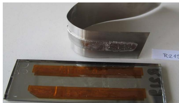
Slika 28: Vzorec R219 po končanem postopku lupljenja z vsebnostjo 0,0025 % aluminija
