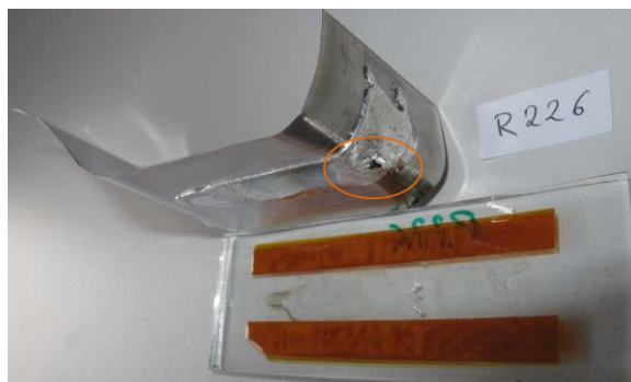
Slika 23: Vzorec R226 po končanem postopku lupljenja z vsebnostjo 0,0075 % aluminija
