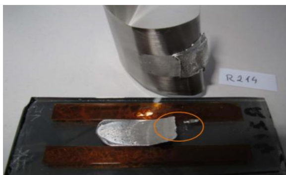
Slika 19: Vzorec R214 po končanem postopku lupljenja z vsebnostjo 0,01 % aluminija
