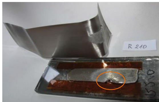
Slika 16: Vzorec R210 po končanem postopku lupljenja z vsebnostjo 0,01 % aluminija
