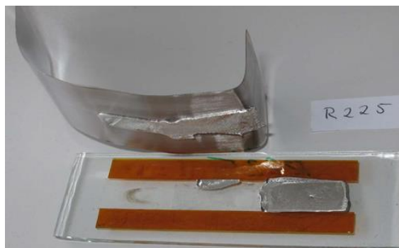
Slika 22: Vzorec R225 po končanem postopku lupljenja z vsebnostjo 0,0075 % aluminija
