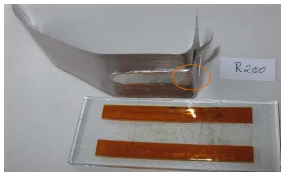
Slika 20: Vzorec R200 po končanem postopku lupljenja z vsebnostjo 0,0075 % aluminija
