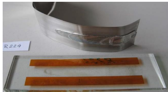
Slika 31: Vzorec R224 po končanem postopku lupljenja z vsebnostjo 0,0025 % aluminija
