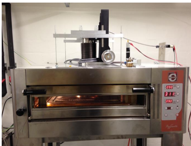
Slika 36: Peč z vgrajeno komoro, ki omogoča injektiranje, ter napravo za spuščanje uteži
