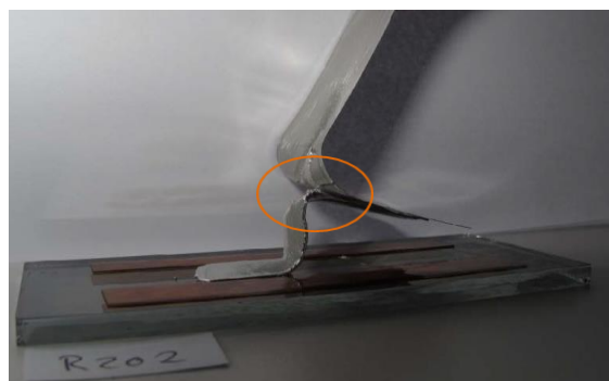
Slika 24: Vzorec R202 po končanem postopku lupljenja z vsebnostjo 0,005 % aluminija
