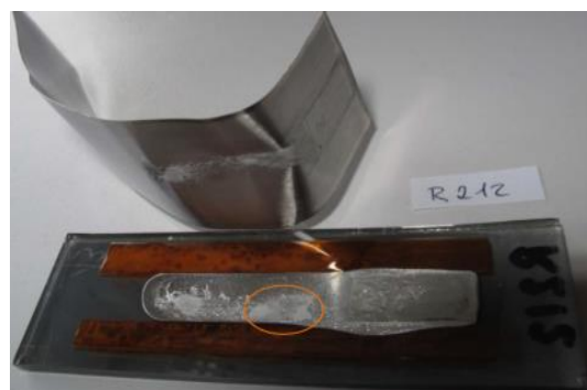
Slika 18: Vzorec R212 po končanem postopku lupljenja z vsebnostjo 0,01 % aluminija
