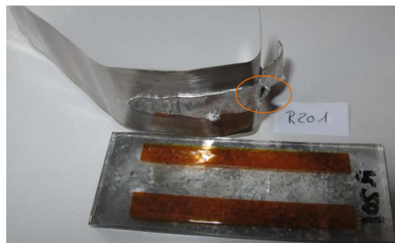
Slika 21: Vzorec R201 po končanem postopku lupljenja z vsebnostjo 0,0075 % aluminija
