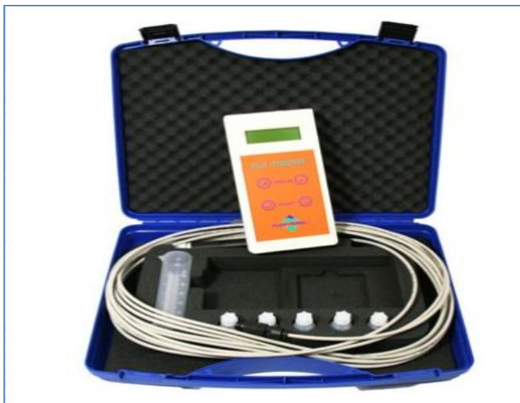
Slika 18: Merilec pretoka Flo-Tracer (Merska oprema, 2015).
