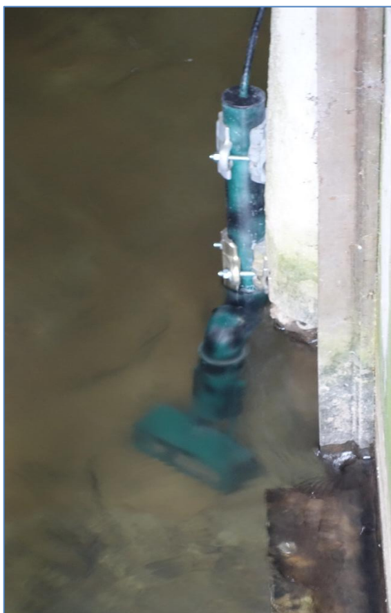
Slika 15: Monitoring rib s kamero, nameščeno pri izhodu iz ribje steze (Ljubljana povezuje, 2015).
