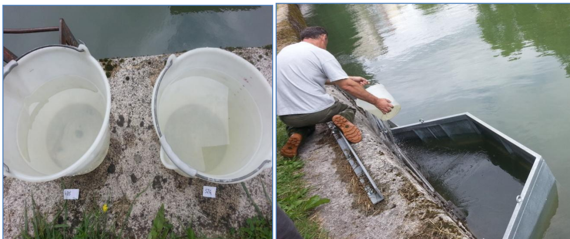
Slika 20: Injeciranje sledila za merjenje pretoka z instrumentom Flo-Tracer.
