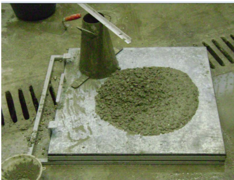
Slika 21: Merjenje poseda na lahkovgradljivi betonski mešanici.
