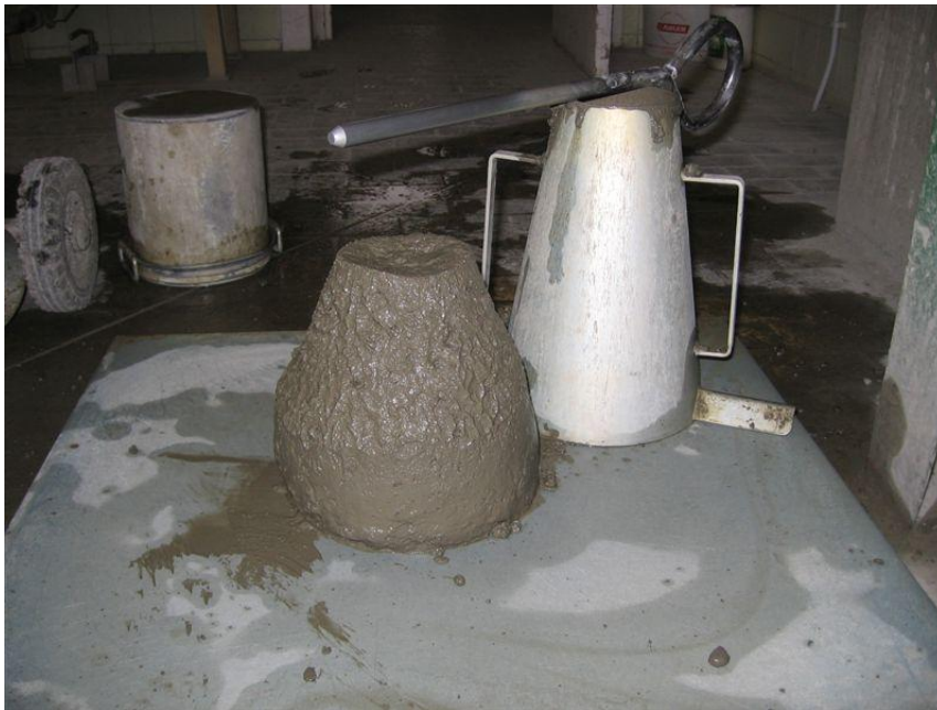
Slika 9: Posed betonskega stožca.
