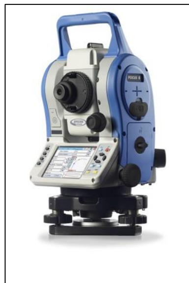
Slika 4: Totalna postaja SPECTRA PRECISION Focus 8 (Geosustavi, 2015b)
