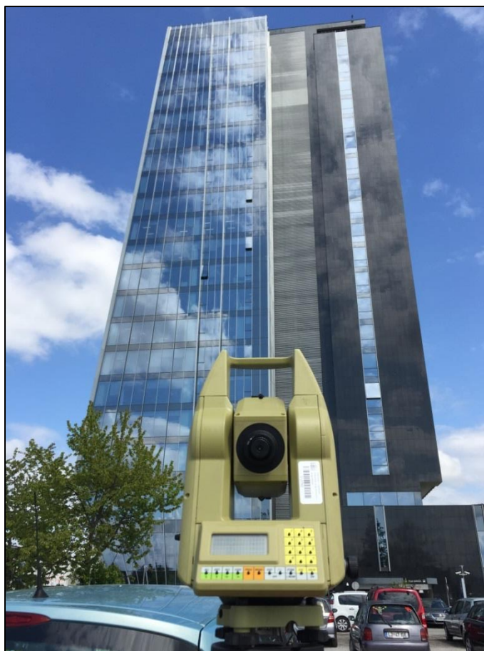
Slika 6: Preizkus natančnosti vertikalnih smeri ob Kristalni palači
