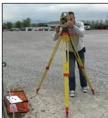
Slika 1: Izvajanje meritev s tahimetrom Leica TC605L
