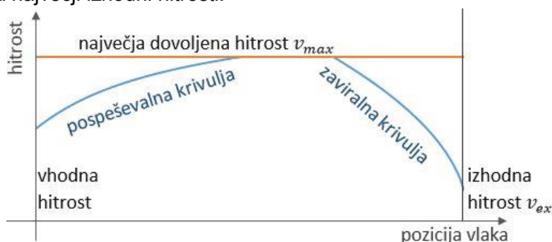
Slika 13: Hitrostni odsek z zaviranjem, kjer vlak doseže največjo dovoljeno hitrost
