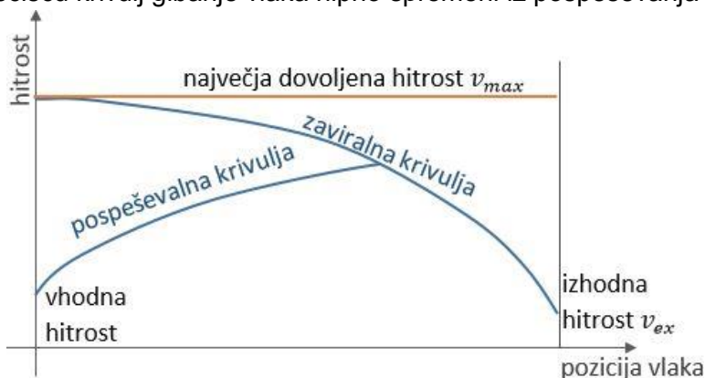
Slika 14: Hitrostni odsek z zaviranjem, kjer pospeševalna krivulja vlaka seka zaviralno krivuljo.
