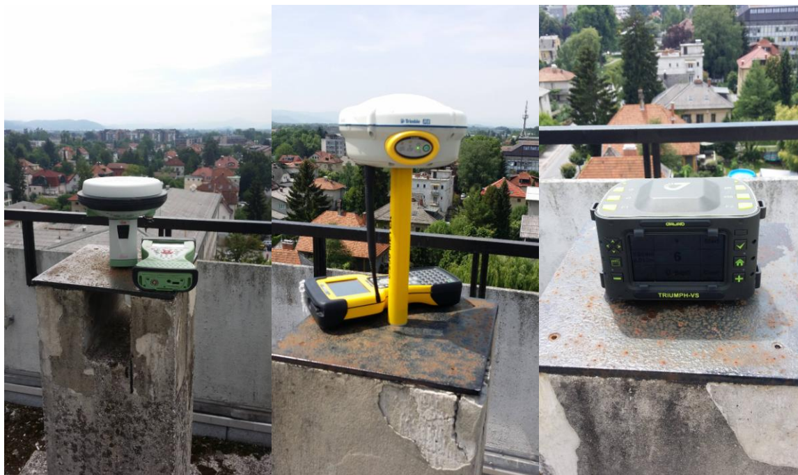
Slika 5: Sprejemniki za izvedbo testiranj na strehi FGG.
