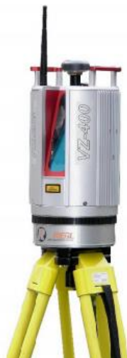
Slika 10: TLS Riegl VZ-400 (vir: [8])
