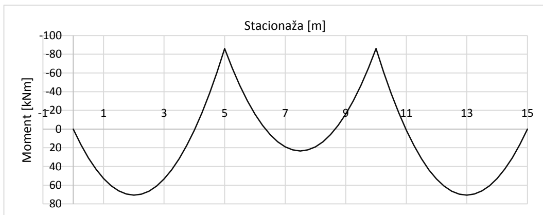
Slika 19: Končna momentna linija pri obtežbi q=35 \text{ kN/m}
